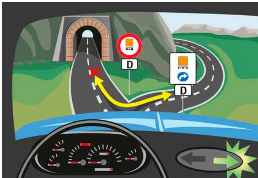
Рис. 6.21. Разрешенное направление движения для транспортного средства, перевозящего опасные грузы № ООН 1001 Ацетилен растворенный и № ООН 1072 Кислород сжатый
