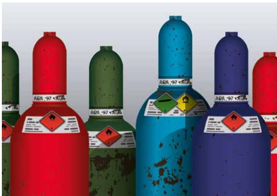
Рис. 5.7. Размещение знаков опасности на баллонах
