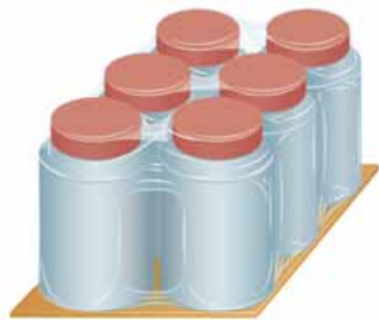
Рис. 5.9. Внутренняя тара на лотках, обернутая в термоусадочный материал или растягивающуюся пленку
