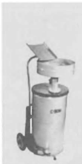
Рис. 7.13. Передвижной маслосборник С 508 с индикатором наполнения бака
